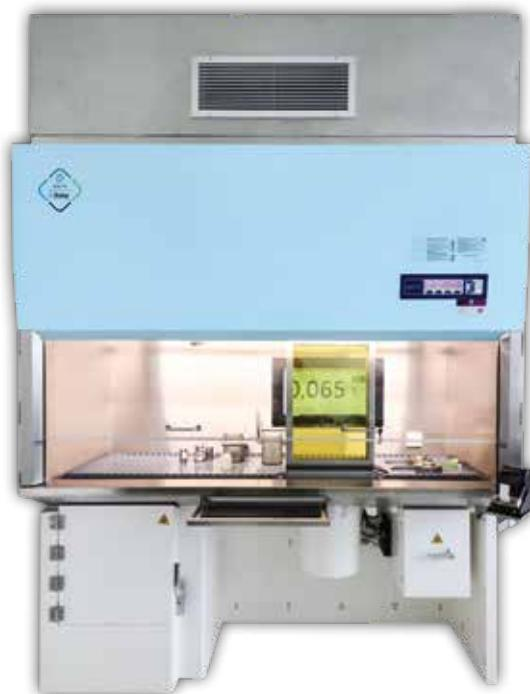
Bleibabgeschirmter radiopharmazeutischer Arbeitsplatz für verschiedene Anwendungsbereiche PET, SPECT und 68-Ga Typ EF-N, der erhöhte Sicherheit für den Nutzer und das Produkt während der Arbeiten mit radioaktiven Substanzen gewährleistet.
